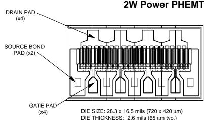
BONDING PADS: 1.9 x 2.4 mils (50 x 60 μm typ.)
