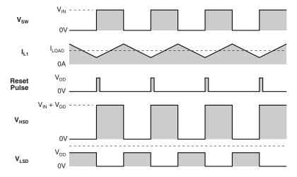
Figure 3. PWM-Mode Timing
