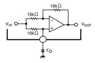
$$\frac{V_{\text{out}}}{V_{\text{in}}} = \frac{1 - j2\pi f \cdot 10k\Omega \cdot C_{\text{D}}}{1 + j2\pi f \cdot 10k\Omega \cdot C_{\text{D}}}$$
