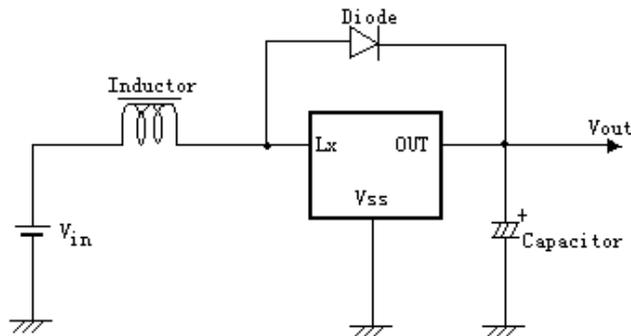
上图是能将输入电压（ $<3.3\text{V}$ ）转换成  $3.3\text{V}$  输出的最基本应用电路。
