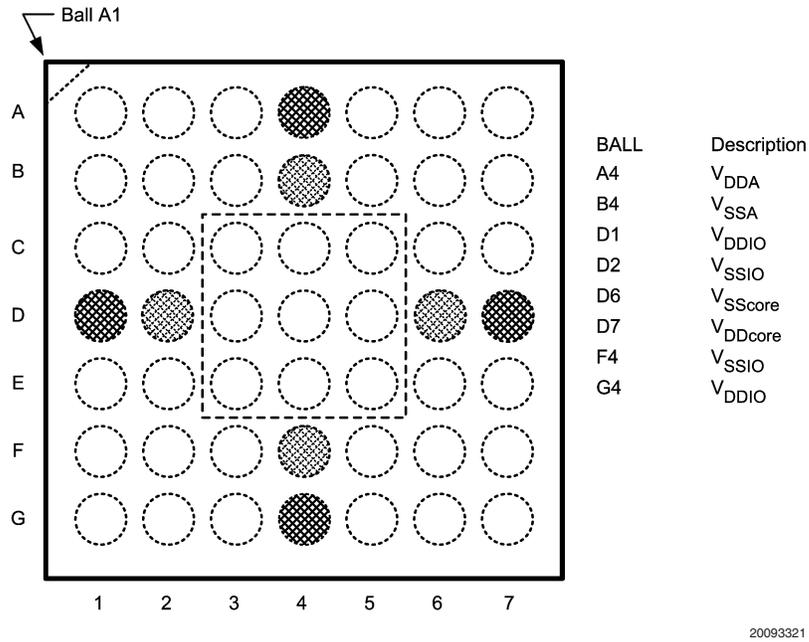
FIGURE 5. LM2502 PWR (V<sub>DD</sub>) and GND (V<sub>SS</sub>) Balls
