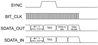
Figure 34. AC-Link Powerdown Timing
