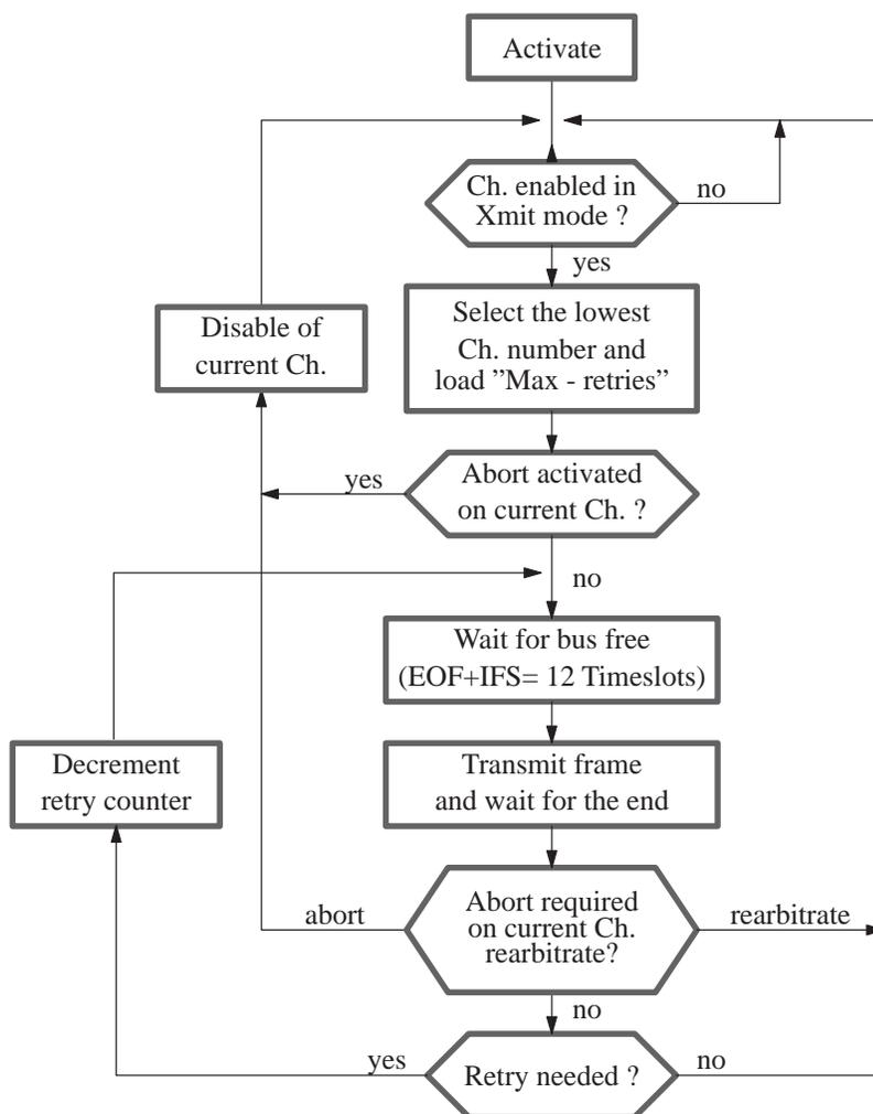
**Figure 25. Transmit function**
