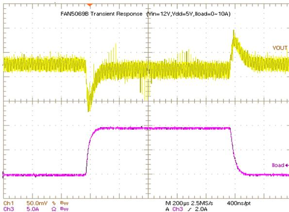
Figure 5. PWM Load Transient (0 to 10A)
