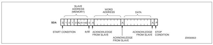
Figure 12. Byte write
