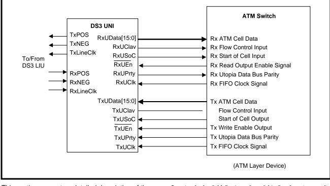
FIGURE 7. SIMPLE ILLUSTRATION OF SINGLE-PHY OPERATION
