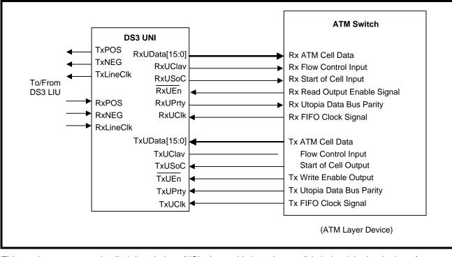
FIGURE 39. SIMPLE ILLUSTRATION OF SINGLE-PHY OPERATION
