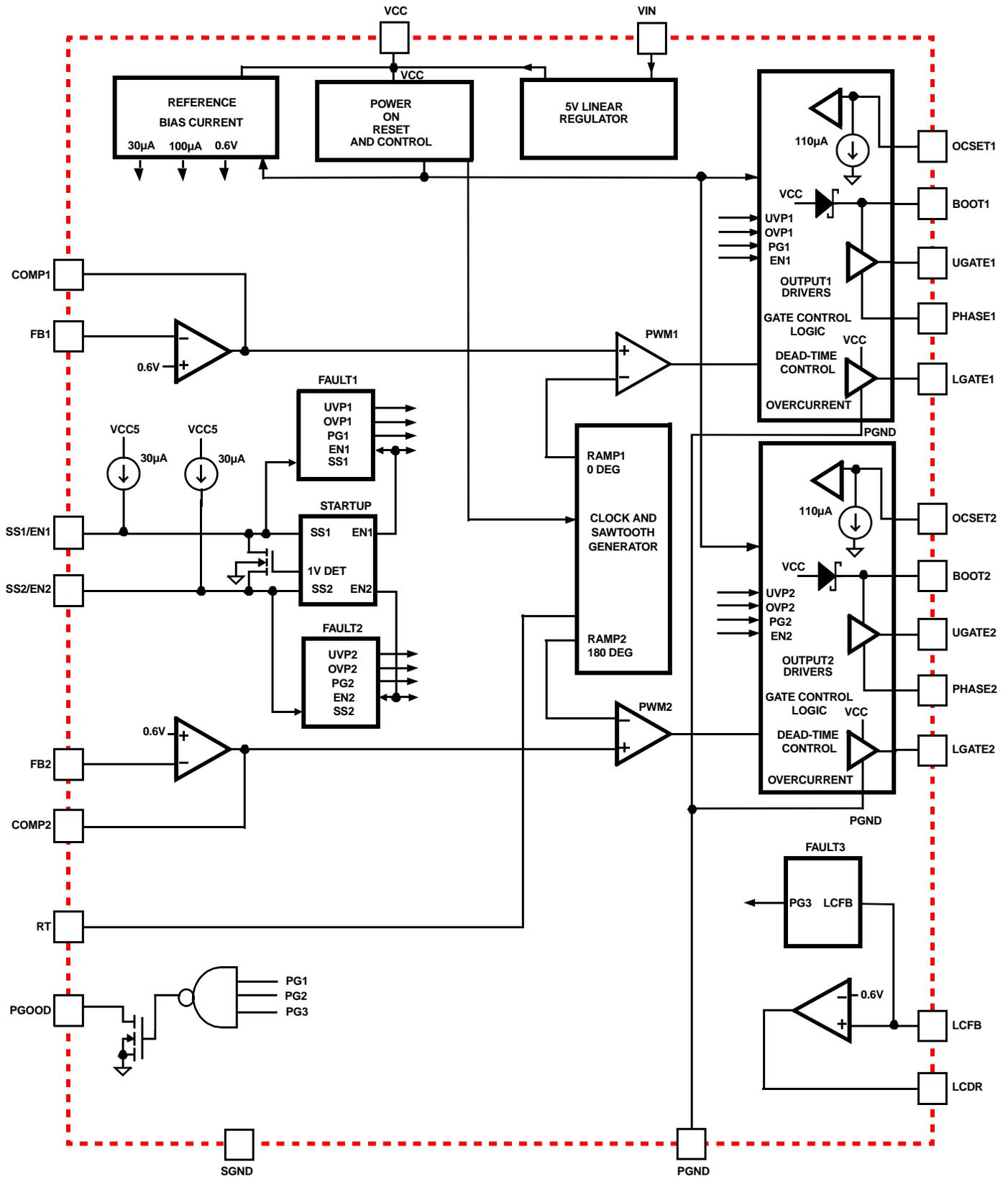
FIGURE 1. BLOCK DIAGRAM
