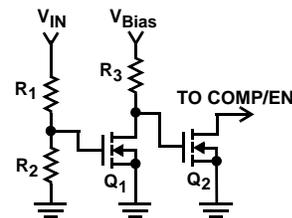
FIGURE 6. SEQUENCER CIRCUIT
