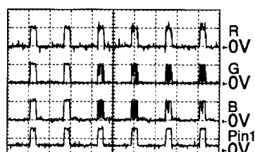
⑪ RGB 500mV/cm, 20 \mu s/cm Pin1 100mV/cm, 20 \mu s/cm mit Uhr / with clock
