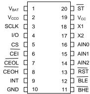
20-Pin TSSOP 20-Pin SOIC
