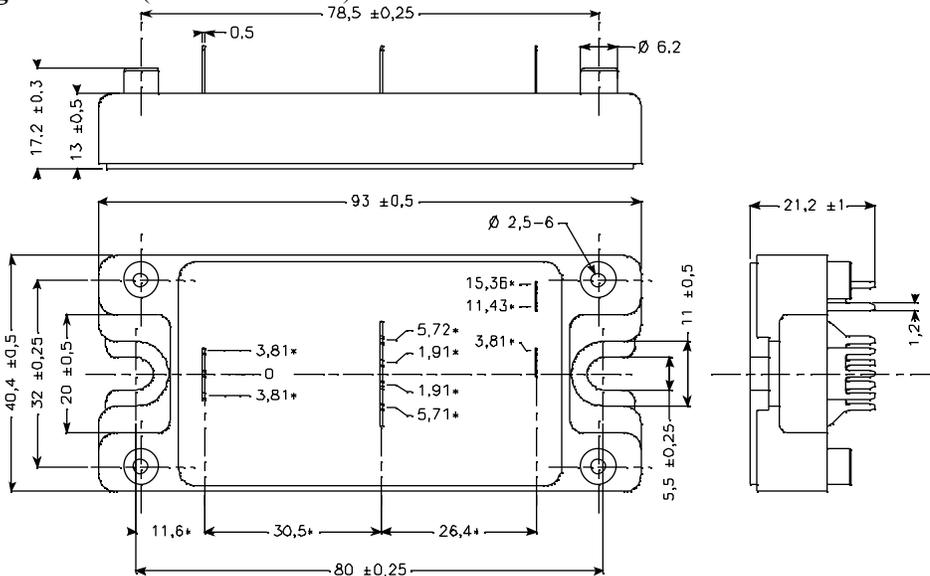
ALL DIMENSIONS MARKED \*\*\* ARE TOLERANCED AS:  $\phi \pm 0,1$
