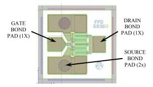
DIE SIZE ( $\mu$ m): 400 x 400  $\mu$ m DIE THICKNESS: 75  $\mu$ m BONDING PADS ( $\mu$ m): >75 x 70
