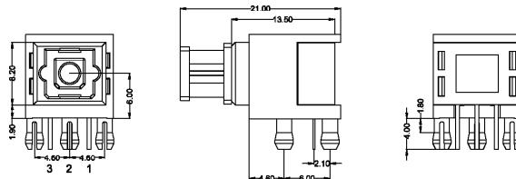
Tolerance:  $\pm 0.2\text{mm}$
