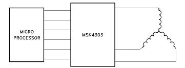
3 PHASE SIX STEP DC BRUSHLESS MOTOR DRIVE OR 3 PHASE SINUSOIDAL INDUCTION MOTOR DRIVE
