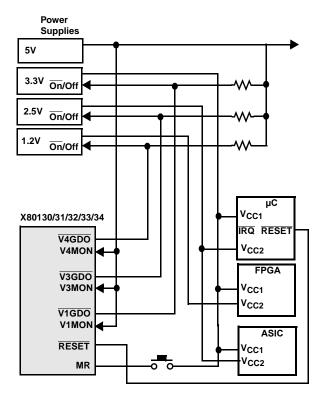
FIGURE 7. EXAMPLE APPLICATION OF PARALLEL POWER CONTROL
