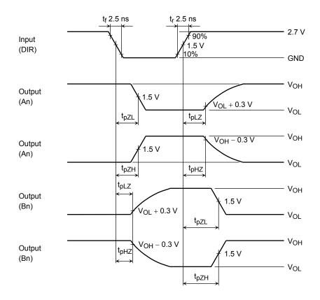
Figure 4 t<sub>pLZ</sub>, t<sub>pHZ</sub>, t<sub>pZL</sub>, t<sub>pZH</sub>
