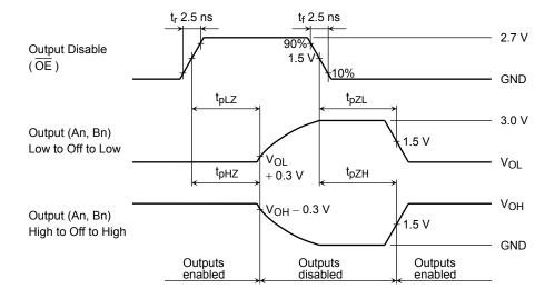
Figure 3  $t_{\text{pLZ}},\,t_{\text{pHZ}},\,t_{\text{pZL}},\,t_{\text{pZH}}$
