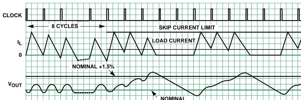
FIGURE 33. SKIP MODE OPERATION WAVEFORMS
