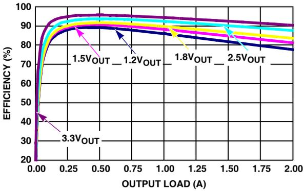
FIGURE 5. EFFICIENCY vs LOAD (1MHz 5VIN PWM)
