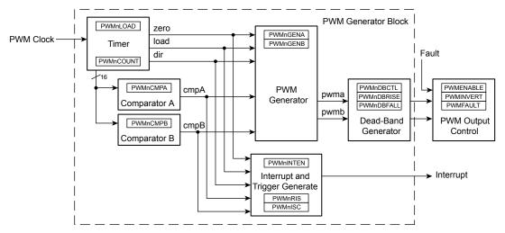
Figure 18-1. PWM Module Block Diagram
