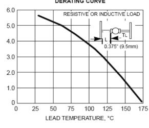
FIG. 1 - MAXIMUM FORWARD CURRENT
