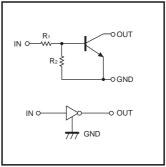
$R_1=2.2k\Omega / R_2=10k\Omega$
