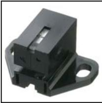
KE2108シリーズは、赤色点光源の発光ダイオードと特殊な受光配列を持つ2ch Photo ICを組み合わせた透過型フォトインタラプタ形状のエンコーダヘッドです。高性能、高信頼性の位置検出システムの構成が容易で、機器の小型化をはかることができます。
