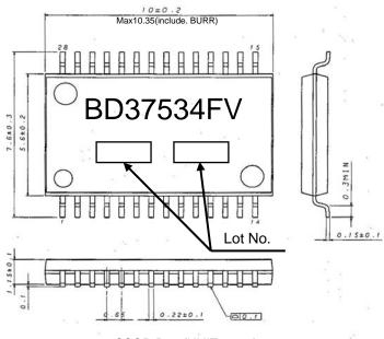
SSOP-B28 (UNIT: mm)
