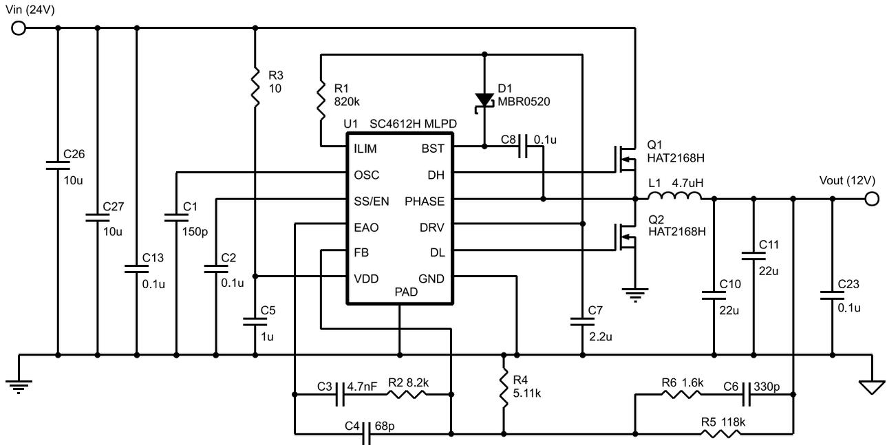
**$V_{IN}=24V$ ;  $V_{OUT}=12V$ ;  $I_{OUT}=8A$ ;  $f_{SW}=600kHz$**
