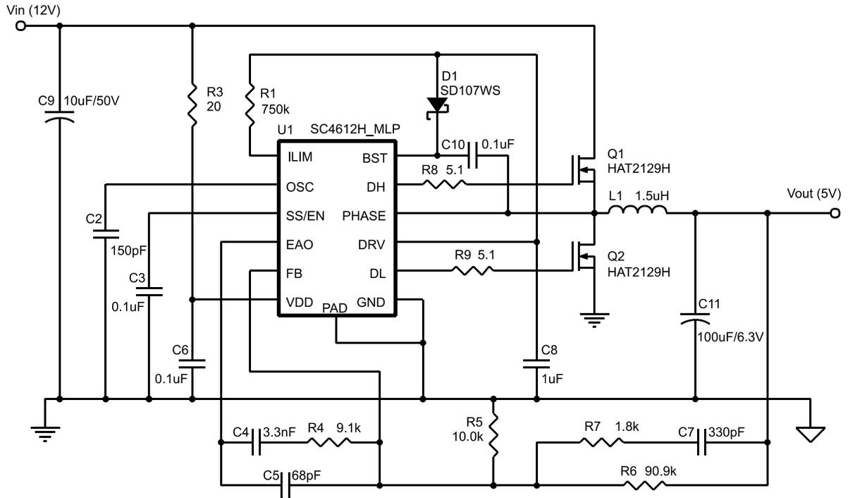
$V_{IN}=12V$ ;  $V_{OUT}=5V$ ;  $I_{OUT}=6A$ ;  $f_{SW}=600kHz$
