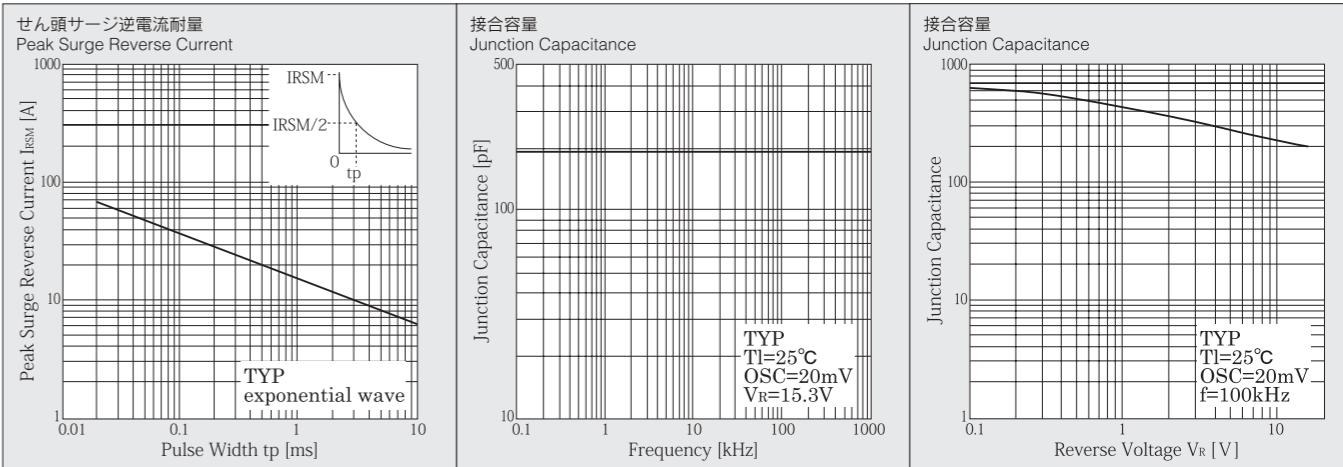
\*Sine waveは50Hzで測定しています。
