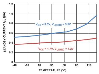
FIGURE 24. STANDBY CURRENT vs TEMPERATURE
