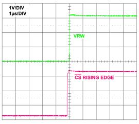
FIGURE 21. WIPER LARGE SIGNAL SETTLING TIME
