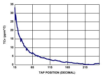
FIGURE 17. 100k TCv vs TAP POSITION
