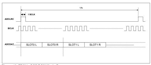
Figure 43 TDM in DSP/PCM Mode B
