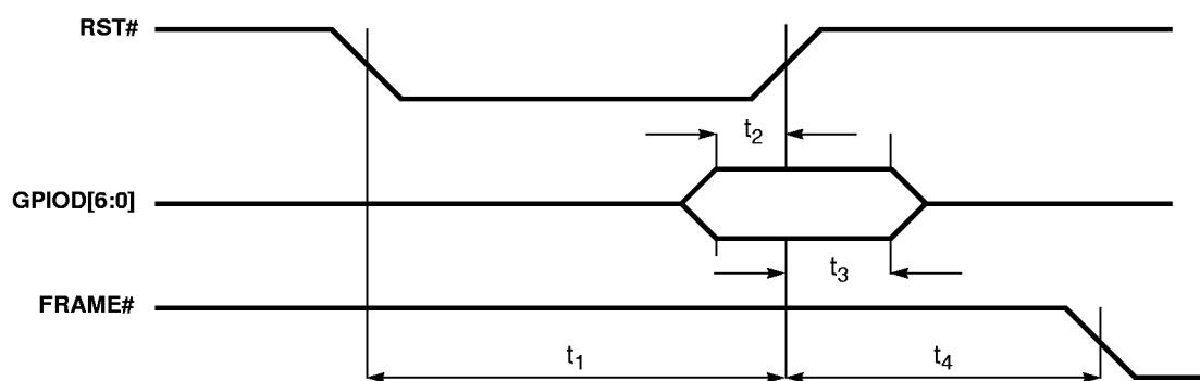
**Figure 11-8. Reset Timing**
