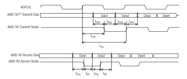
Figure 20. AGP 2x Timing Diagram
