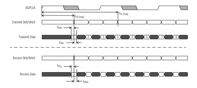
Figure 21. AGP 4x Timing Diagram
