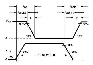
FIGURE 12. RESISTIVE SWITCHING WAVEFORMS
