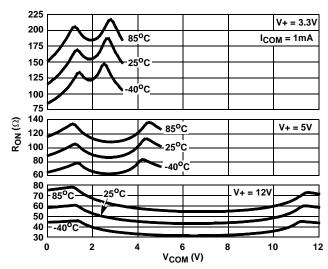
FIGURE 10. ON RESISTANCE vs SWITCH VOLTAGE
