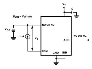
FIGURE 5. R<sub>ON</sub> TEST CIRCUIT
