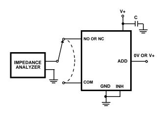
FIGURE 7. CAPACITANCE TEST CIRCUIT
