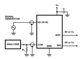
FIGURE 4. OFF ISOLATION TEST CIRCUIT
