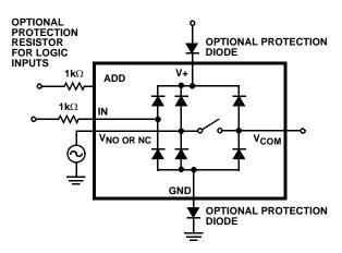
FIGURE 8. OVERVOLTAGE PROTECTION
