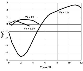
FIGURE 16. CHARGE INJECTION vs SWITCH VOLTAGE
