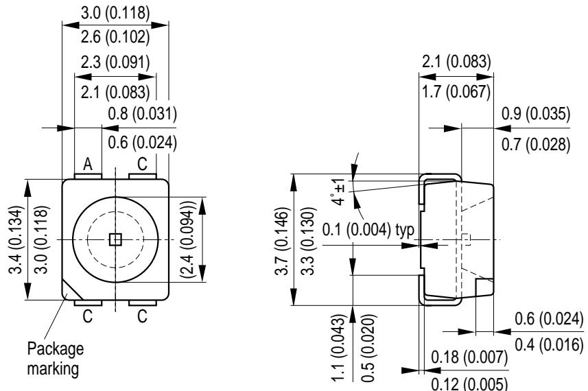
Maße werden wie folgt angegeben: mm (inch) / Dimensions are specified as follows: mm (inch).
