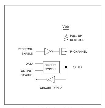
Figure 1-8. Pin Circuit Type D
