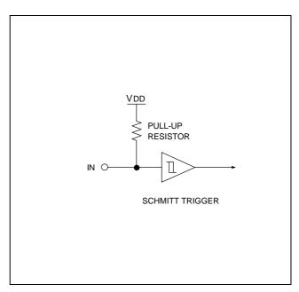
Figure 1-5. Pin Circuit Type B
