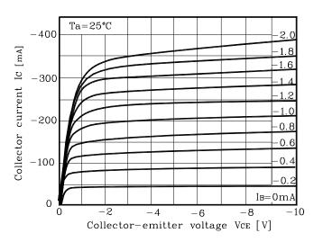
Fig. 4  $V_{\text{CE(SAT)}}$  -  $I_{\text{C}}$
