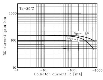
Fig. 6  $h_{\text{FE}}$  -  $I_{\text{C}}$
