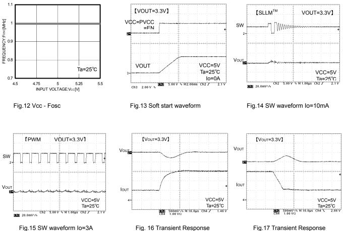
Fig. 16 Transient Response Io=1→3A(10µs)
