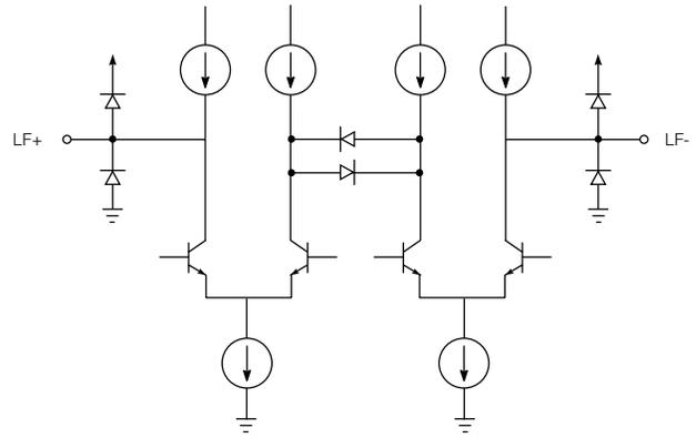
Fig. 2 Loop Filter
