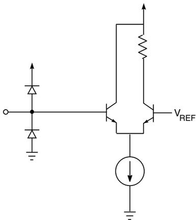
Fig. 1 TTL Inputs
