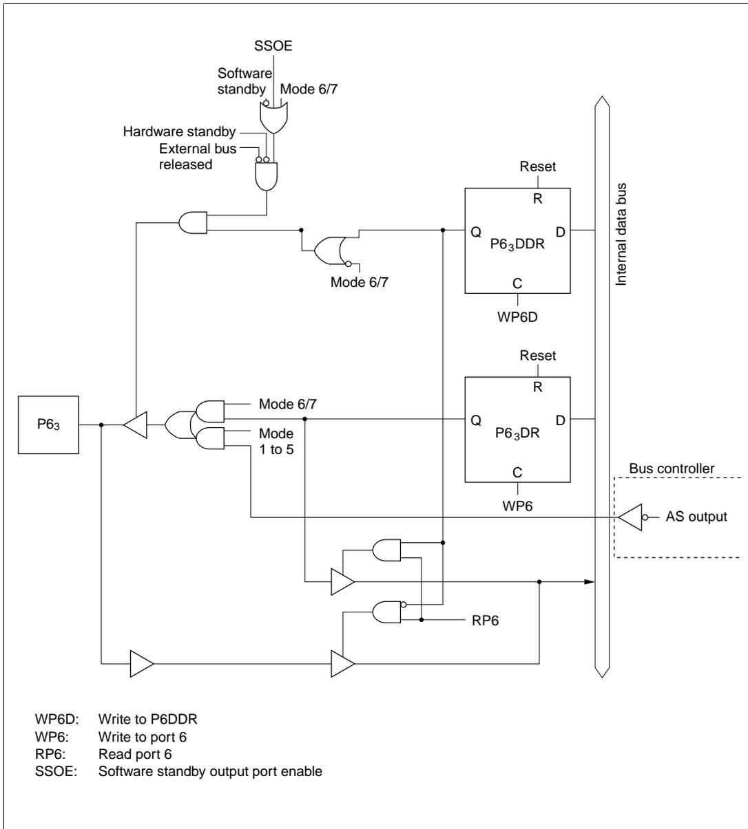
**Figure C.6 (d) Port 6 Block Diagram (Pin P6<sub>3</sub>)**
