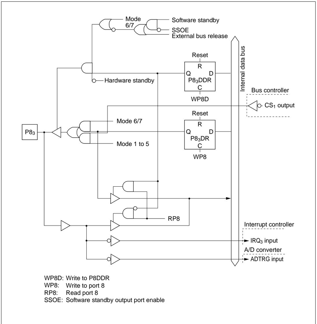
**Figure C.8 (d) Port 8 Block Diagram (Pin P8<sub>3</sub>)**
