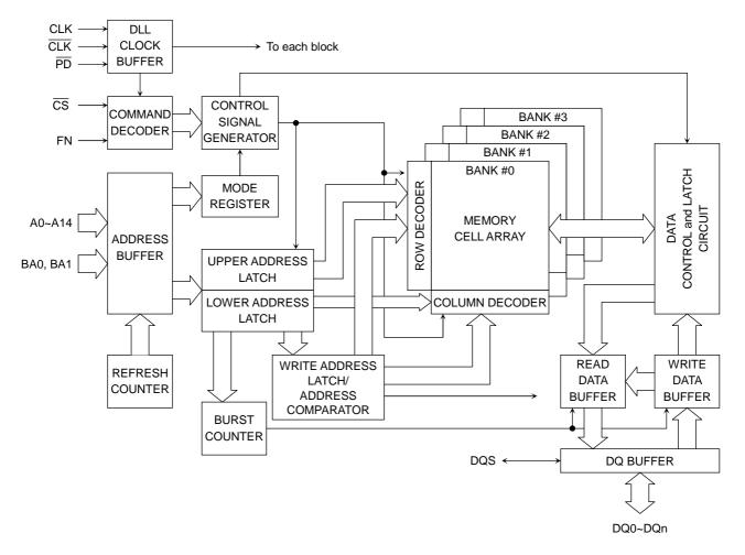
Note: The TC59LM806CFT configuration is 4Bank of 32768 × 256 × 8 of cell array with the DQ pins numbered DQ0~DQ7. The TC59LM814CFT configuration is 4Bank of 32768 × 128 × 16 of cell array with the DQ pins numbered DQ0~DQ15.
