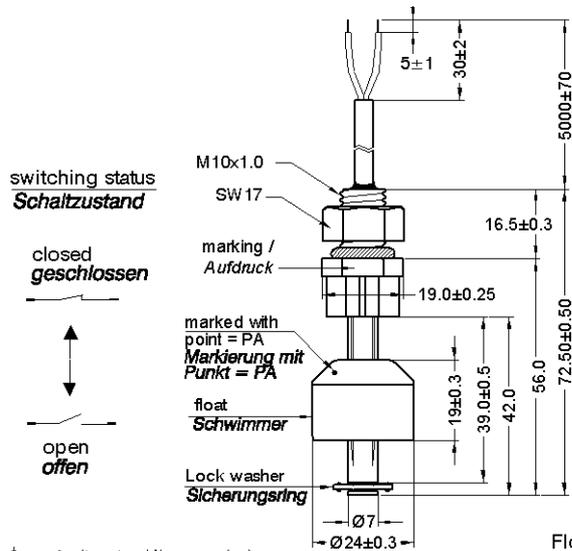
dimensions / Abmessungen (mm)
