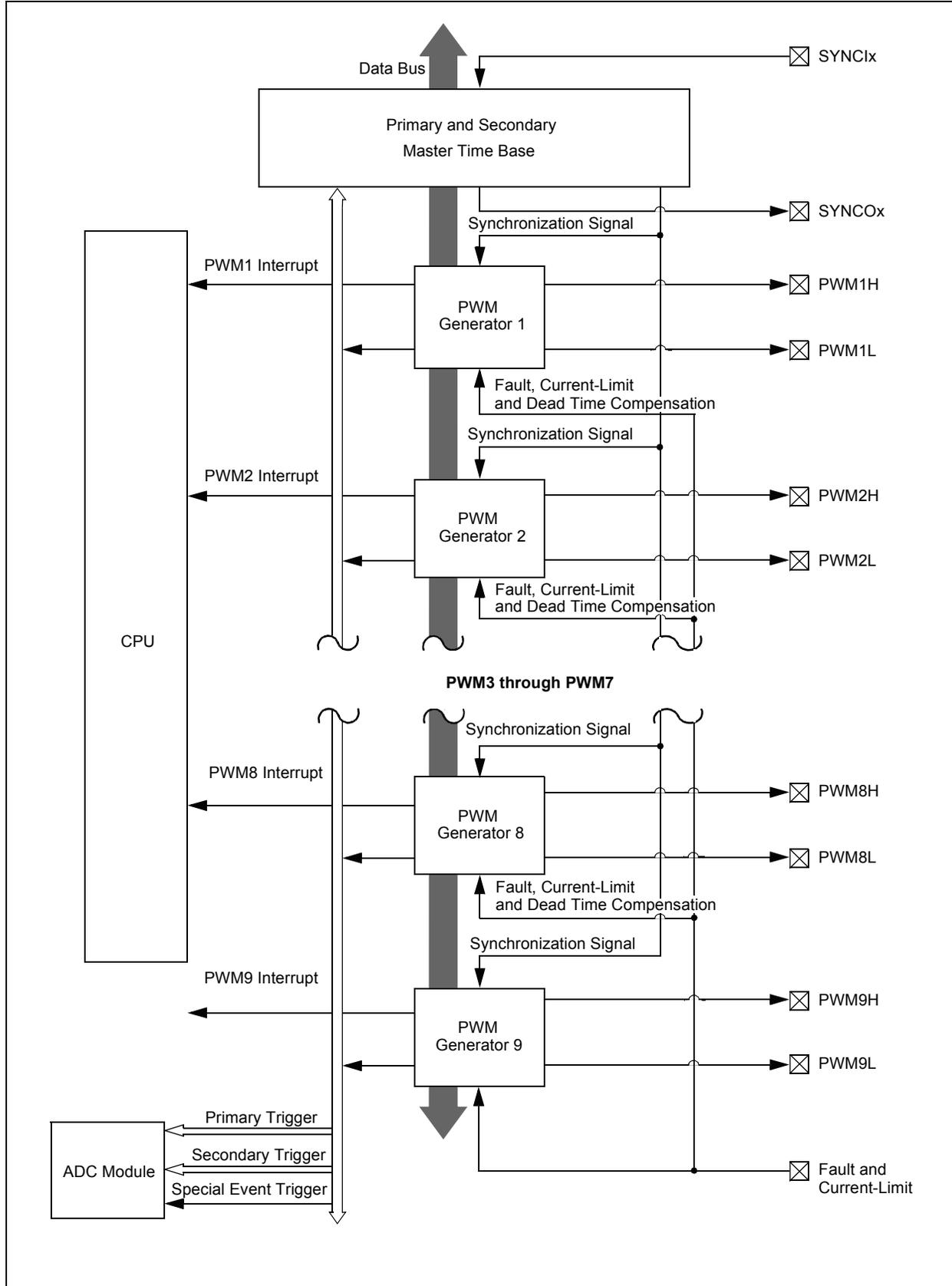
FIGURE 16-2: HIGH-SPEED PWM MODULE REGISTER INTERCONNECTION DIAGRAM
