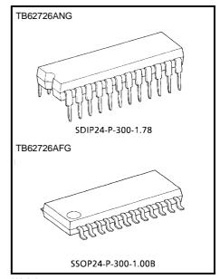
Weight SDIP24-P-300-1.78: 1.22 g (typ.) SSOP24-P-300-1.00B: 0.32 g (typ.)
