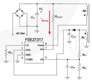
Figure 28. HV Startup Circuit
