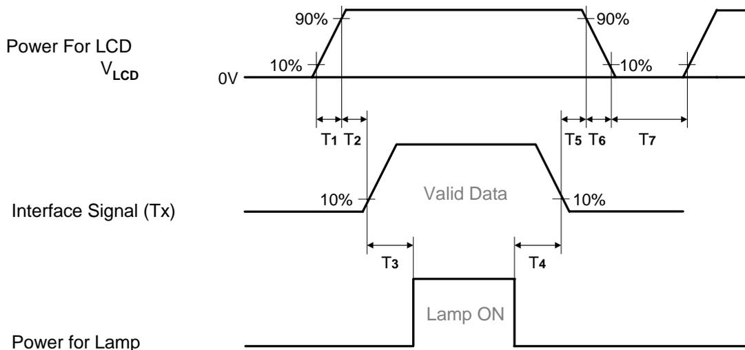
**Table 8. POWER SEQUENCE FOR LCD DRIVING CIRCUIT**
