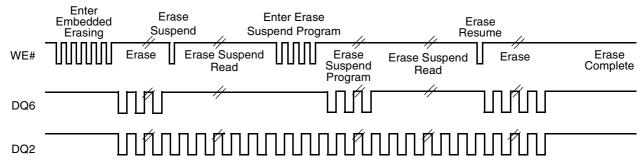
**Note:** DQ2 toggles only when read at an address within an erase-suspended sector. The system may use OE# or CE#f to toggle DQ2 and DQ6.
