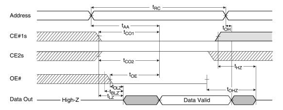
Figure 30. SRAM Read Cycle
