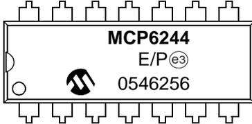
14-Lead SOIC (150 mil) (MCP6244)
