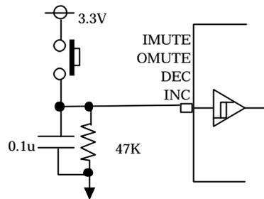
Figure 10 チャタリング抑制回路例
