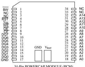
34-Pin POWERCAP MODULE (PCM) (USES DS9034PC POWERCAP)
